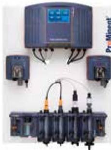
Komplettsystem DULCODOS Pool Comfort mit DULCOPOOL Pro Regler für die pH-Wert-Einstellung und Desinfektion mit flüssigen Chlorprodukten. Abhängig von der Anforderung und der Umwälzmenge werden Schlauchpumpen der Baureihe DULCOFLEX, Motordosierpumpen Typ alpha oder Magnetdosierpumpen Typ beta eingesetzt.
