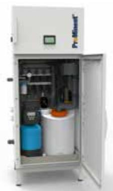
Die CHLORINSITU Ila Baureihe kombiniert die erprobte und robuste Bauweise der ungeteilten Elektrolysezelle mit innovativem Design. Bei einer Steigerung der Salz- und Stromausbeute wird eine ausgezeichnete Qualität der Hypochloritlösung erreicht. Der Chloratgehalt des Produkts liegt unter dem in der EN 901 vorgegebenen Grenzwert.
