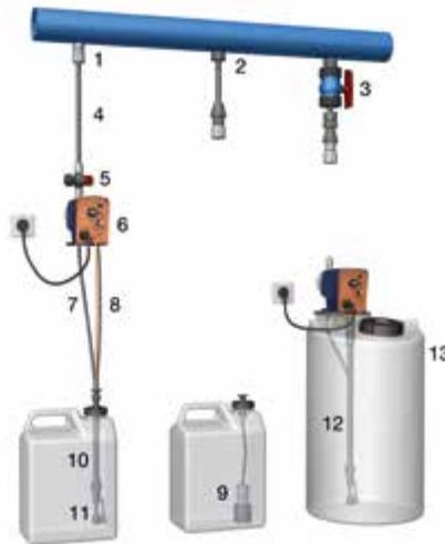
Um in eine Leitung dosieren zu können, werden neben der **Dosierpumpe (6)**, der **Leitung (4)** und dem Dosiermedium noch hydraulische Zubehörteile gebraucht.
