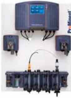
Komplettsystem DULCODOS Pool Soft für die pH-Wert-Einstellung und chlorfreie Desinfektion mit Aktivsauerstoff. Um Resistenzbildungen der im Schwimmbad möglichen Keime gegen Aktivsauerstoff zu verhindern, erfolgt die Dosierung nicht kontinuierlich sondern Timer-gesteuert als Stoßbehandlung. Alternativ ist eine Regelung über Sensor möglich.
